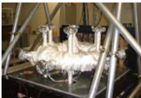
図9 真空容器ベーキング及び排気試験の様子
